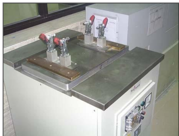
Figure III-17: Table à vibrante (Laboratoire de lafarge M'sila)
