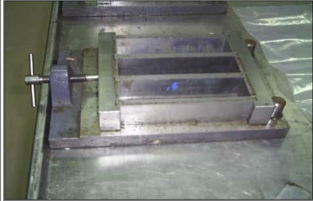
Figure III-15: Eprouvette Prismatique ( 4 \times 4 \times 16 \text{ cm}^3 )
