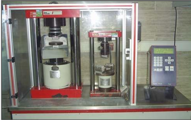
Figure III-20 : Machine de Compression (Laboratoire de lafarge M'sila)
