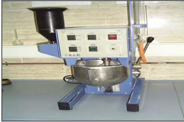
Figure III-14: Malaxeur semi-automatique de mortier
