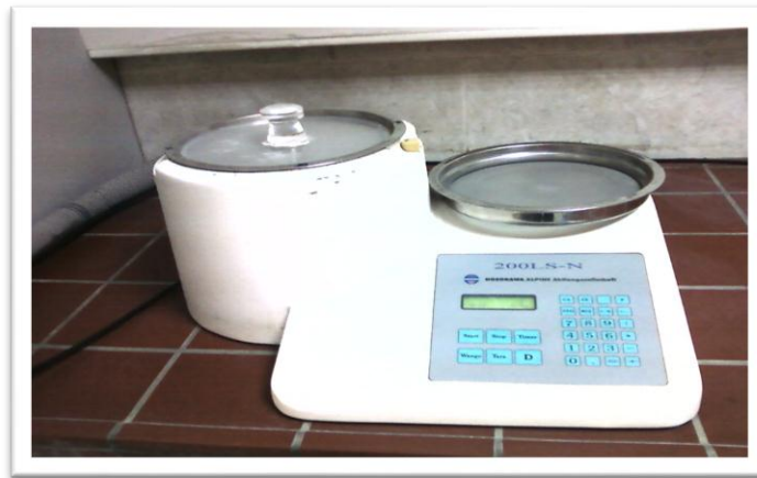
Figure III-7: Tamiseuse Alpine (Laboratoire de Lafarge M'sila) .
