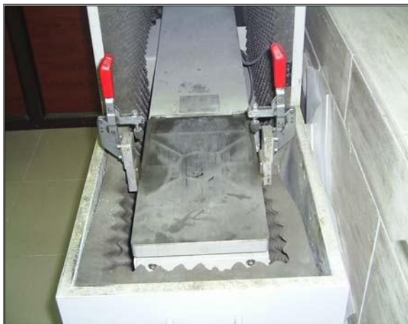
Figure III-16: Table à choc (Laboratoire de lafarge M'sila)
