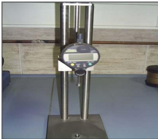
Figure III-22 : Comparateur de Retrait (Laboratoire de lafarge M'sila)
