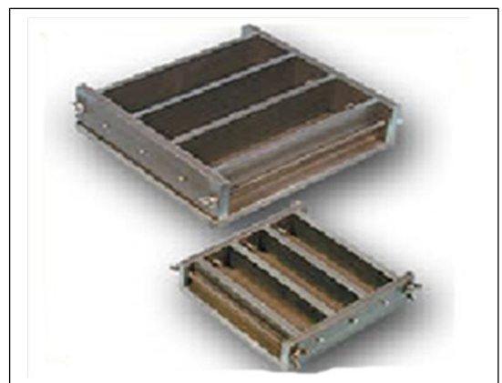
Figure III-21: Moules ( 4 \times 4 \times 16 ) \text{cm}^3 Équipés de plots de Retrait
