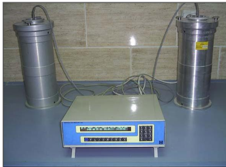
Figure III-23 : Calorimètre Langavant (Laboratoire de lafarge M'sila).
